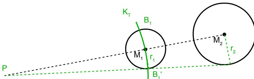
Die Geraden  $PB_1$ ,  $PB_1'$  sind die beiden „äußeren“ Tangenten an die gegebenen Kreise. Die Schnittpunkte der Tangenten mit dem Kreis  $K_{M_2; r_2}$  sind die Punkte  $B_2$ ,  $B_2'$ , wobei  $B_1$ ,  $B_2$  und  $B_1'$ ,  $B_2'$  auf jeweils gleichen Seiten der Mediane liegen.
