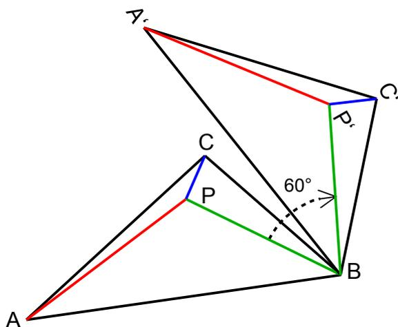
Ergänzt man die Figur durch die Verbindungslinien  $CC'$ ,  $PP'$ , so ergeben sich die gleichseitigen Dreiecke  $\triangle BPP'$ ,  $\triangle BCC'$ , und der Streckenzug  $APP'C'$  hat die Länge  $|P-A| + |P-B| + |P-C|$ .
