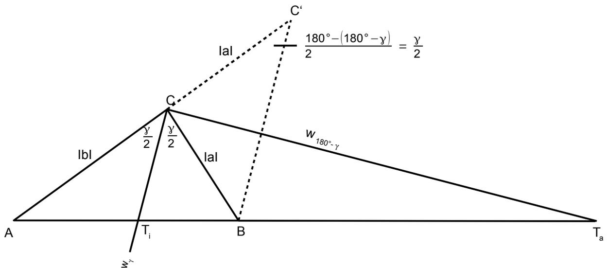
Der Winkel bei  $C'$  ist  $\frac{180^\circ - (180^\circ - \gamma)}{2} = \frac{\gamma}{2}$
