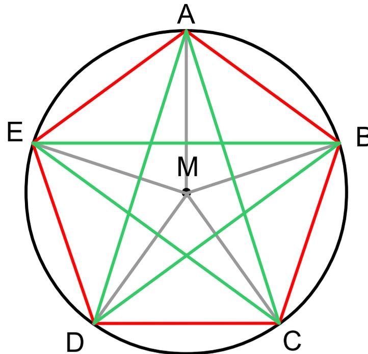
Da die Sehnen  $\overline{AB}$ ,  $\overline{BC}$ ,  $\overline{CD}$ ,  $\overline{DE}$ ,  $\overline{EA}$  jeweils den Mittelpunktswinkel von  $72^\circ$  haben, ergeben sich an den Ecken  $A$ , ...,  $E$  jeweilige Umfangswinkel zu  $36^\circ$ .
